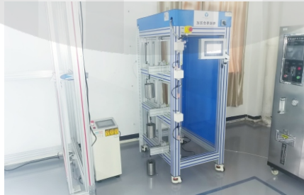
05. 电锁耐用测试设备 (意林750kg磁力锁通过100万次耐用测试)
